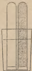
Рис. 80. Наблюдение над объемом воздуха при ржавлении железа.
