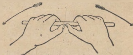
Рис. 223. Ломание надрезанной стеклянной трубки.
