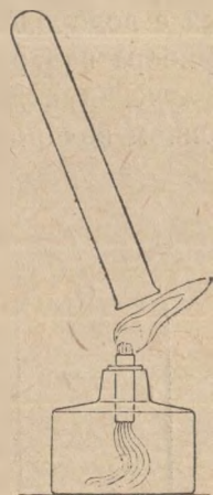
Рис. 60. Испытание собранного водорода.
