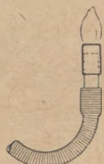
Рис. 64. Пламя водорода. На конец стеклянной трубки надета металлическая насадка.
