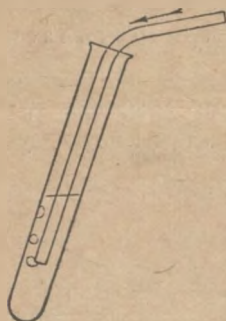
Рис. 21. Пропускание выдыхаемого воздуха через известковую воду.
