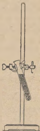
Рис. 33. Пробирка со смесью серы и железа.
