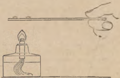
Рис. 50. Выпаривание капель жидкостей на стеклянной пластинке.
