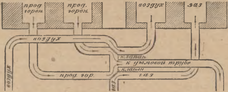
Рис. 212. (Наверху) печь Сименса-Мартена (продольный вертикальный разрез).
