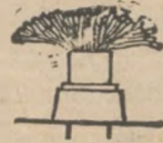
Рис. 227. Фитиль спиртовой лам- почки, распро- вленнный в виде веера.
