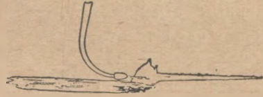
Рис. 143. Вдувание воздуха в пламя керосина.
