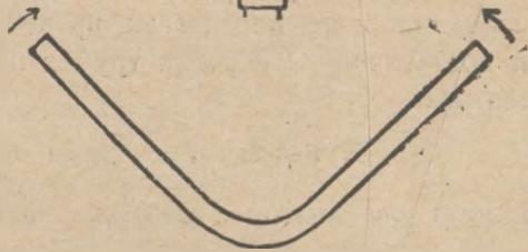
Рис. 228. Нагревание стеклянной трубки в плоском пламени.
