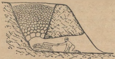
Рис. 32. Простейшая печь для обжига известняка (разрез). Известняк выкладывается в яму, устроенную на склоне горы. Снизу разводится огонь.
