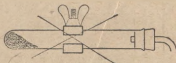
Рис. 27. Пробирка, неправильно укрепленная в зажиме штатива.
