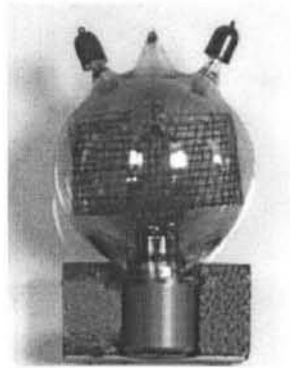
Рис. 1. Лампа “Бабушка” – первый образец ламп, разработанных в 1916 г. М.А. Бонч-Бруевичем. Экспонат Политехнического Музея (ПМ) в г. Москве.
