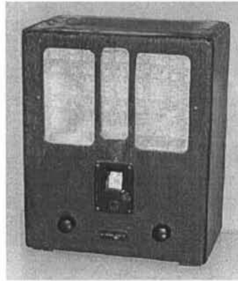
"4НБС-6" ("Четырехламповый Настольный Батарейный"). Модель 1939 года. Воронежский завод "Электросигнал". Из коллекции автора.
