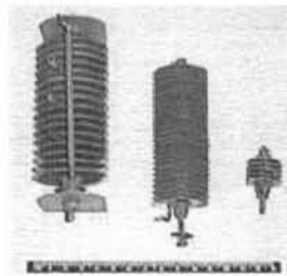
Рис. 53. Селеновые выпрямители с открытыми шайбами. 1930-е - 1950-е годы. Выпрямляющий слой на основе селенового напыления. Применялись в приемниках АРЗ-49, "Москвич-В" и некоторых других.
