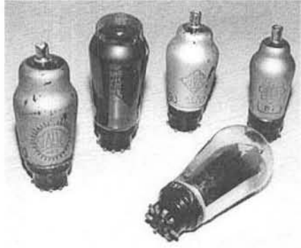
Рис. 7. Европейские лампы с цоколем "паук". 4-вольтовый косвенный накал. Конец 1930-х годов. На фото: AK2, AL4, AF3, ABC1, AZ1 производителей "Valvo" и "Telefunken G.m.b.H.". В СССР лампы с таким цоколем не выпускались. Из коллекции автора.
