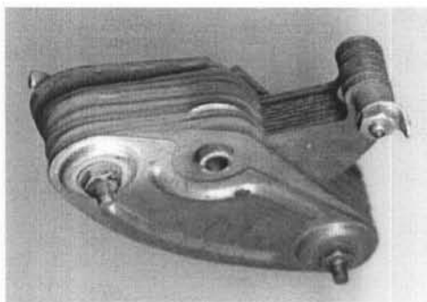
Рис. 31. Конденсаторный блок переменной емкости с твердым диэлектриком. Воронежский завод “Электросигнал”, 1934 год. Из коллекции автора.
