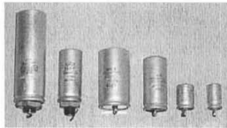
Рис. 47. Оксидные конденсаторы "КЭ". (1950-1960) ("Конденсатор Электролитический"). Диэлектрик - бумага, пропитанная пастообразным электролитом, обкладки - губчатая поверхность алюминиевой фольги. Корпус - алюминий. Выпускались с 1940-х по 1950-е годы. Широко применялись в качестве фильтров в цепях анодного питания. Из коллекции автора.
