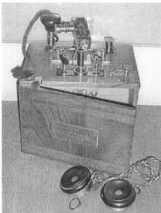
Рис. 1. Один из первых образцов телефонного приемника А.С. Попова. Фирма Ducretet, Париж. ЦМС им. А.С. Попова, СПб.
