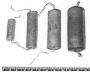
Рис. 38. Конденсаторы "КБ" ("Конденсатор бумажный"). До 1941 г. именовались "БК". Обкладки - алюминий, диэлектрик - бумага в парафине. Корпус - пропарафиненная бумага. Выпускались с 1930-х по 1960-е годы. Из колл. автора.
