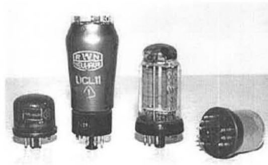
Рис. 9. Лампы с цоколем типа "Т" (8 профилированных штырьков). Слева - металлическая лампа военного применения EF14 фирмы "Telefunken". Далее - UCL11, YU13 и вакуумный счетчик импульсов N3 фирмы "Dressler". В СССР лампы с таким цоколем не выпускались. Из колл. автора.
