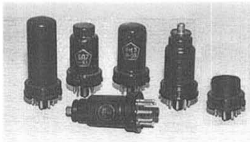
Рис. 10. Лампы переходных маркировок. Слева - 4Ф6С, выпускавшаяся в 40-50 годах взамен 6X5, справа - отечественные Z-62-D (впоследствии - 6Ж6С), 6SA7 (6A7), 6SR7 (6Г1), 6V6GT (6П6С) выпуска конца 40-х годов. Последней показана лампа 1515 со специальной маркировкой. Из коллекции автора.
