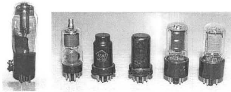
Рис. 10. Лампы переходных маркировок. Слева - 4Ф6С, выпускавшаяся в 40-50 годах взамен 6X5, справа - отечественные Z-62-D (впоследствии - 6Ж6С), 6SA7 (6A7), 6SR7 (6Г1), 6V6GT (6П6С) выпуска конца 40-х годов. Последней показана лампа 1515 со специальной маркировкой. Из коллекции автора.
