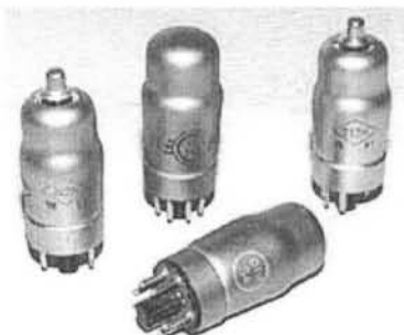
Рис. 13. Отечественные малогабаритные лампы батарейной серии ("малгабы"). 2-вольтовый прямой накал, цоколь октальный. Начало 1940-х годов. Внешнее проводящее покрытие служит экраном. На фото: 2Ж2М, СО-243, 2К2М, СБ-243. Из коллекции автора.
