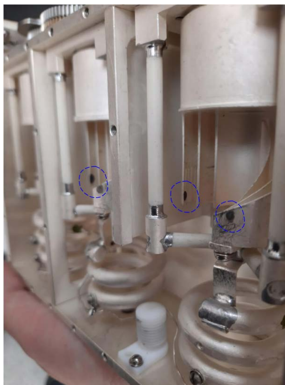
Рис. 5. Вид опытного образца ППФ 4-го порядка (без крышки) после пробоя 170Вт на частоте 250 МГц
